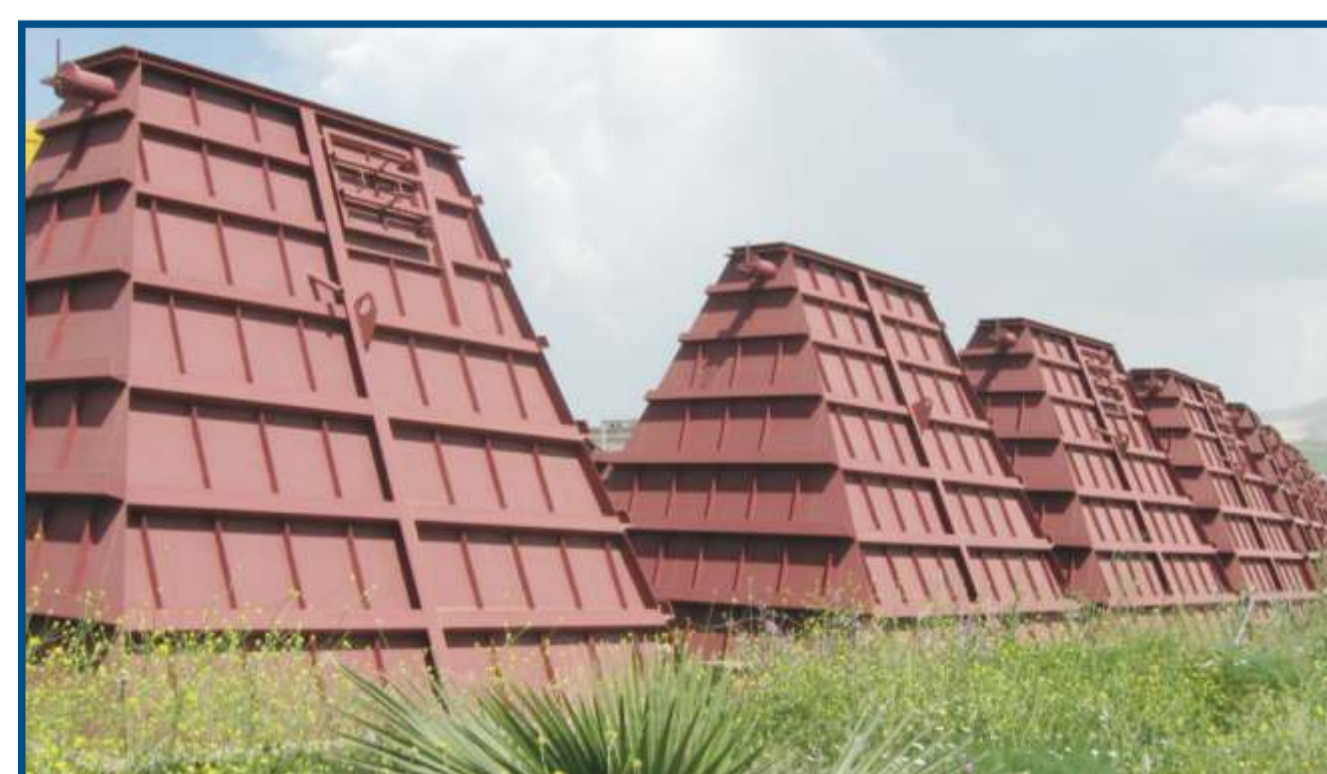
TREMIES FILTRE À MANCHES CIMENTERIE SAÏDA
